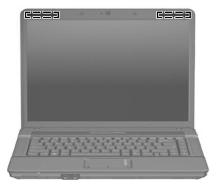
HINWEIS: Achten Sie im Sinne einer optimalen Übertragung darauf, dass sich keine Gegenstände in unmittelbarer Umgebung der Antennen befinden.
