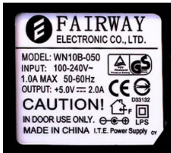
Abbildung 4-2: Steckernetzteil - elektrische Werte
