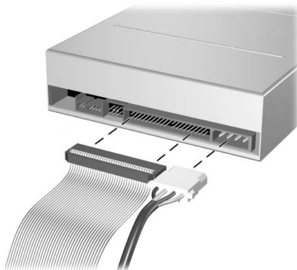
Anschließen der Strom- und Datenkabel
